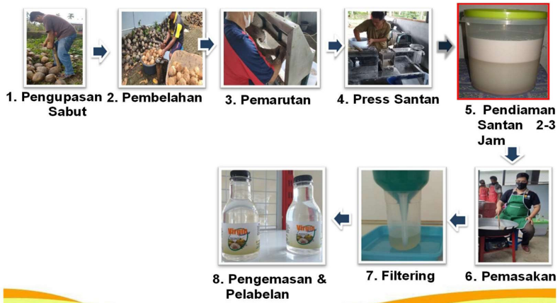
Gambar 44 Tahapan pembuatan VCO dengan pemanasan
