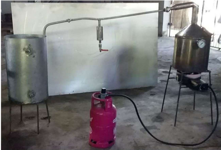
Gambar 50 Alat pirolisis pembuatan asap cair
