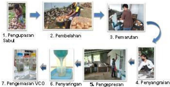
Gambar 42 Proses pembuatan VCO metode DME
