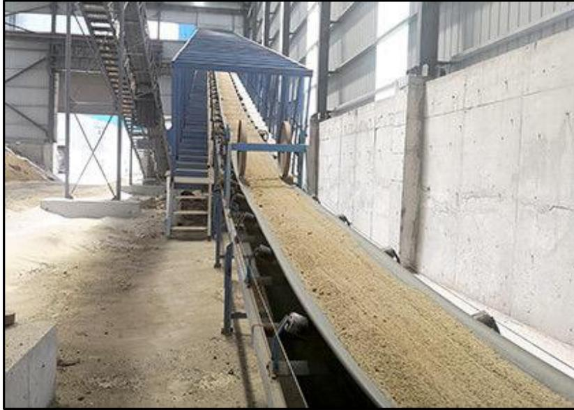
Gambar 9. *Belt confeyor* (ban berjalan) membawa pupuk setelah proses produksi untuk dilakukan pengemasan
