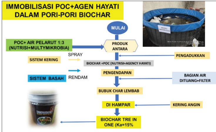
Gambar 26 Proses immobilisasi arang menjadi Biotron
