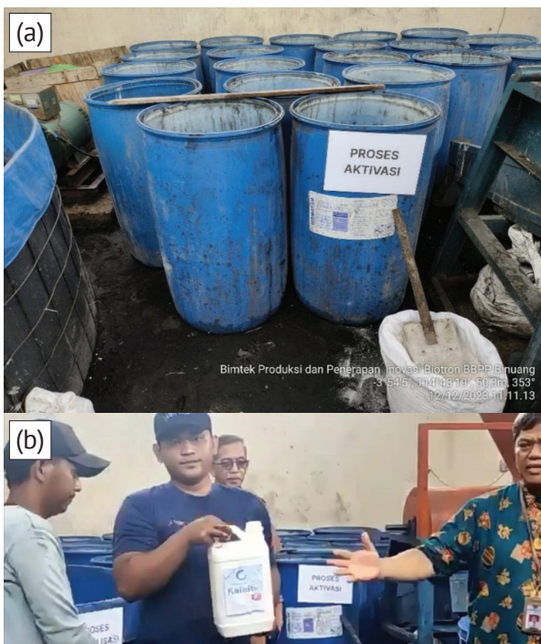
Gambar 25 Proses aktivasi meliputi dua tahap yakni a) proses alkalisasi ( \text{CaO} , \text{NaOH} , \text{KOH} , \text{MgOH} ) dan b) proses katalisasi ( \text{Na} , \text{K} , \text{Mg} , \text{Fe} , \text{Zn} , \text{Cu} , dan \text{Mn} )
