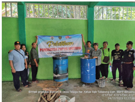
Gambar 21 Fasilitas sederhana pirolisis kapasitas 100 kg bahan (Sumber: Budiono, 2023)
