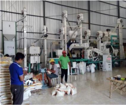
**Gambar 8.** Proses penggilingan gabah dengan RMU di Gapoktan Pojok Kulon Desa Pojok Kulon Kecamatan Kesamben, 4 Juni 2020
