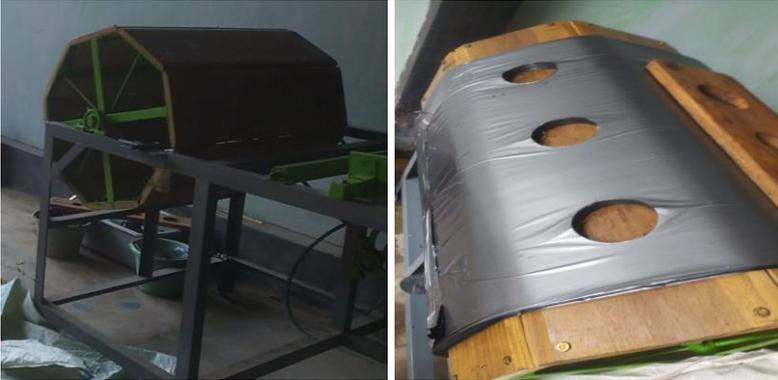
Gambar 3. Contoh mesin pelubang mulsa sederhana
