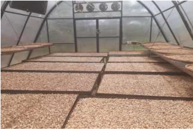
Pengeringan dengan solar dome dryer
