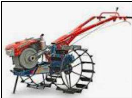
Gambar 30 TR 2 dengan roda besi standar direkomendasikan untuk lahan dengan kekerasan tanah tinggi
