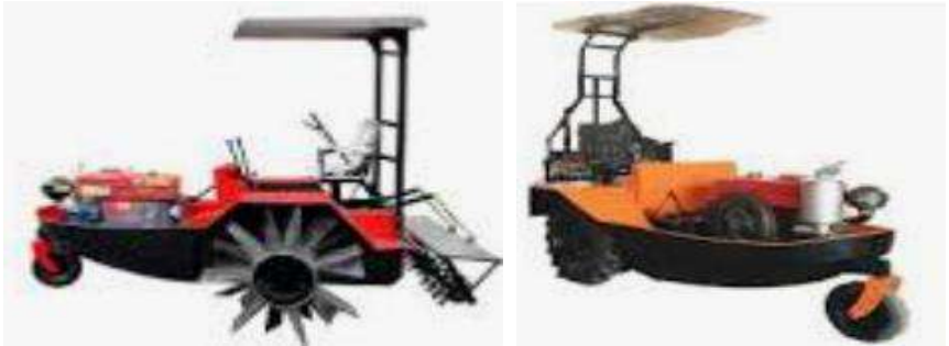
Gambar 34 Traktor perahu untuk mengolah tanah berlumpur sedang dengan cara diglebeg di belakang traktor
