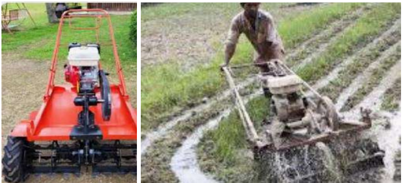
Gambar 35 Traktor kura-kura untuk mengolah tanah berlumpur sedang dengan cara diglebeg, yang diletakkan di belakang traktor
