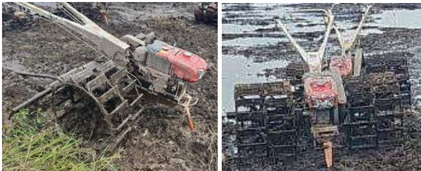
Gambar 32 TR 2 dengan roda besi ganda untuk lahan kekerasan tanah dengan kekerasan sedang
