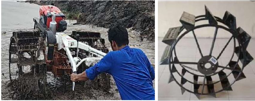
Gambar 31 TR 2 dengan roda besi berdiameter besar dengan sirip lebar untuk lahan dengan kekerasan tanah baik/cukup
