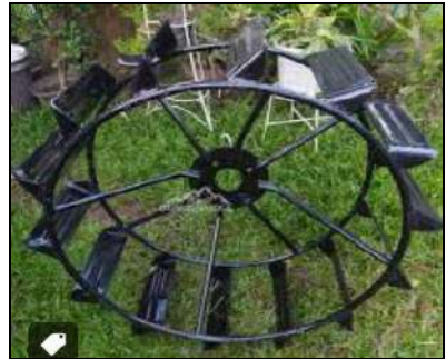
Gambar 30 TR 2 dengan roda besi standar direkomendasikan untuk lahan dengan kekerasan tanah tinggi
