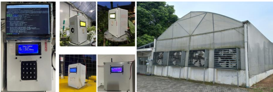
Gambar 15. Sistem kontrol adaptif untuk rumah tanaman di kawasan beriklim tropika dengan model jaringan syaraf tiruan
