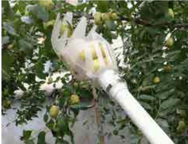
Gambar 4. Alat petik buah pala harus mampu mencegah buah jatuh langsung ke tanah (Sumber: www.lazada.co.id );
