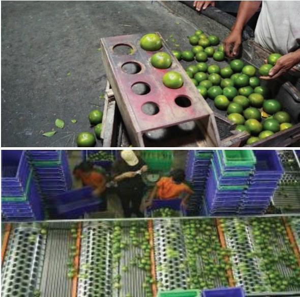
Gambar 26. Pengkelasan Buah Jeruk Dengan Alat Konvensional dan Modern
