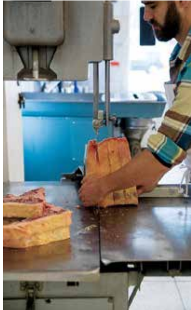
Gambar 15. Gergaji pita membuat pekerjaan yang cepat saat memotong atau membagi ( portioning ) potongan utama daging berupa lulur atau has ( loin ) sapi menjadi daging steak yang rata
