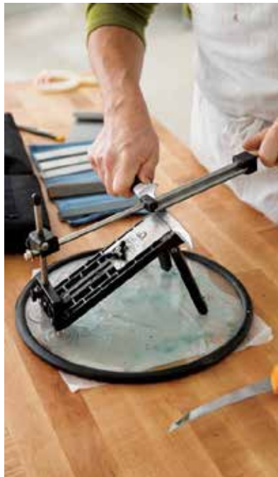
Gambar 5. Alat Edge Pro untuk mengasah pisau dengan memastikan sudut kemiringan pisau yang konsisten
