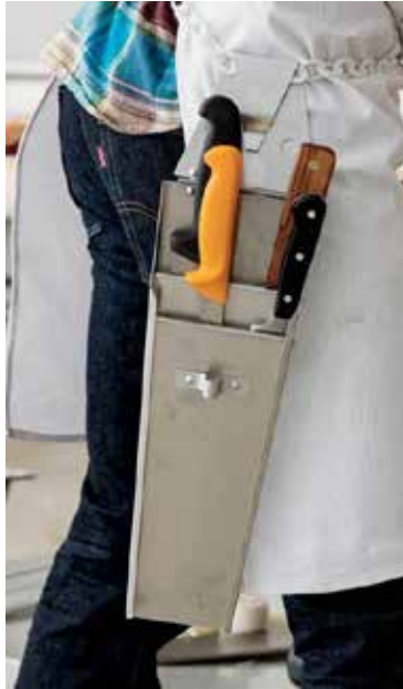
Gambar 6. Wadah pisau ( scabbard ) melindungi mata pisau ( edge ), sekaligus membantu mencegah cedera yang tidak disengaja akibat pisau yang salah tempat atau terserak.
