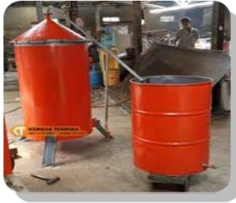
Gambar 5. Alat penyulingan minyak atsiri
