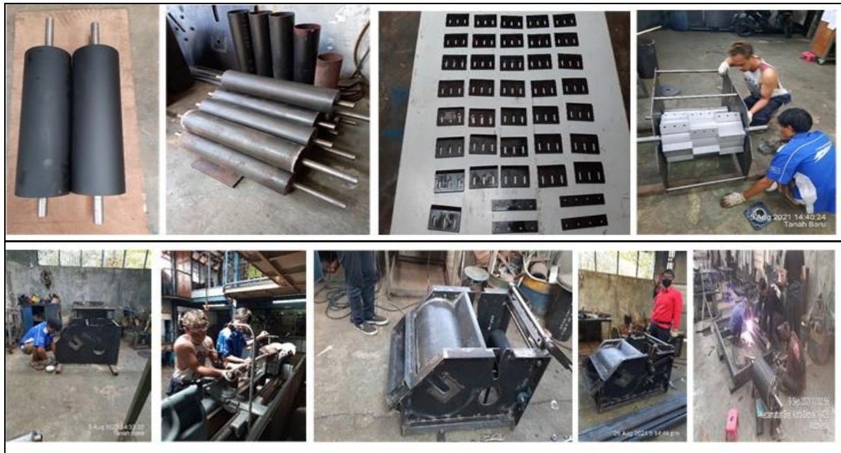
Gambar 47. Pembuatan komponen roller belt conveyor , pisau pencacah dan rumah silinder pencacah
