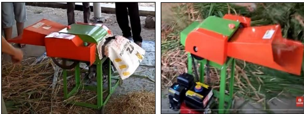
Gambar 10. Berbagai model mesin pencacah jerami tipe cross flow buatan industri alsintan lokal dan dipasarkan didalam negeri
