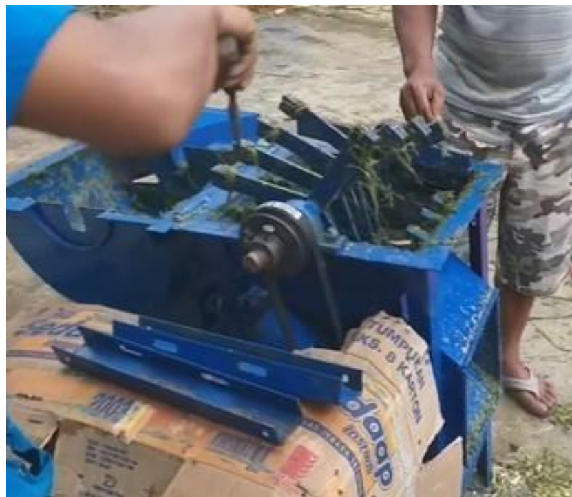
Gambar 8. Susunan pisau mesin pencacah jerami tipe axial
