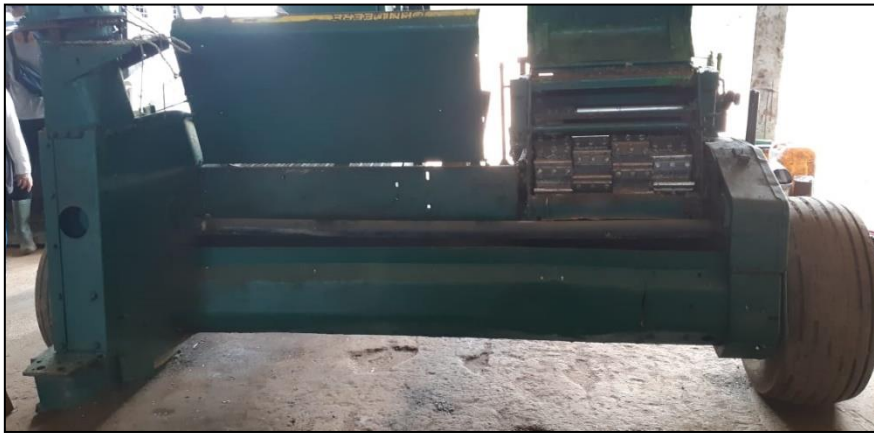
Gambar 13. Mesin pencacah produk samping tanaman jagung tipe silinder ( cross flow ) produksi John Deer, Amerika yang digunakan oleh PT KASA di Lampung
