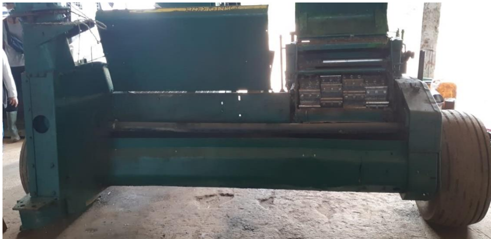
Gambar 11. Mesin pencacah biomassa tanaman jagung tipe silinder ( cross flow ) produksi Jhon Deer, Amerika yang digunakan oleh PT KASA di Lampung
