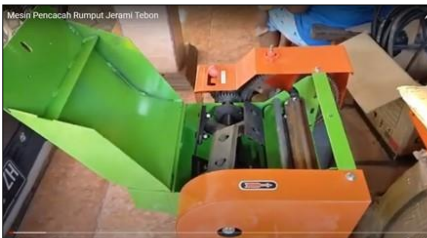
Gambar 14. Susunan pisau mesin pencacah jerami tipe cross flow
