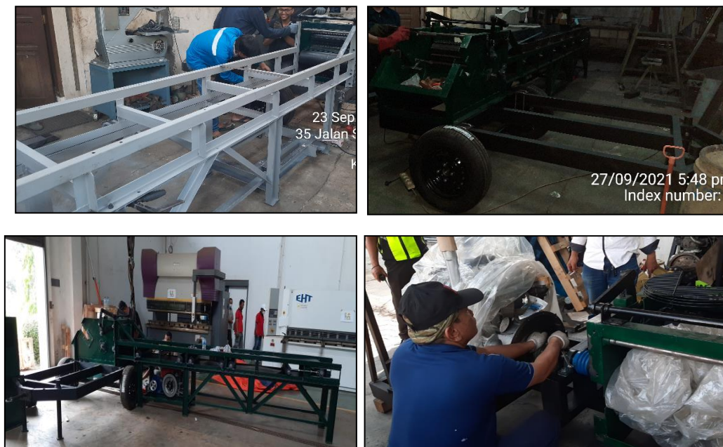
Gambar 37. Perakitan kerangka belt conveyor , kerangka chopper , engine dan v belt dan puli
