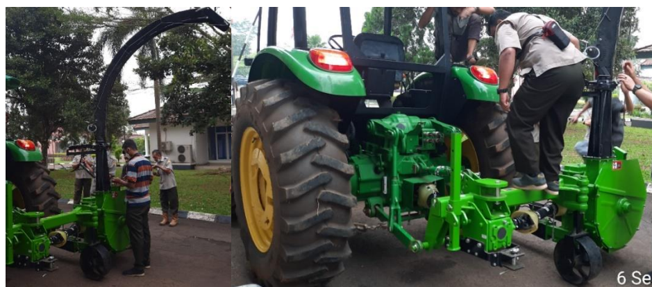
Gambar 32. Implement mesin pemanen hijauan pakan telah terpasang pada traktor roda 4 berdaya 60 HP siap diuji fungsi
