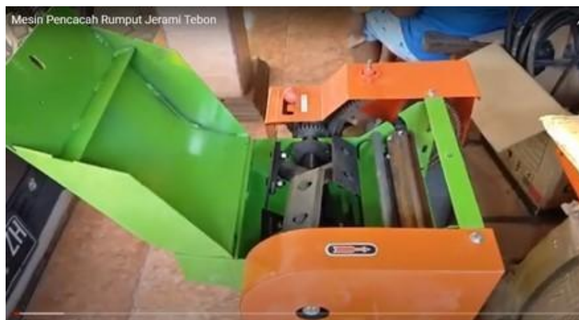
Gambar 12. Susunan pisau mesin pencacah jerami tipe cross flow
