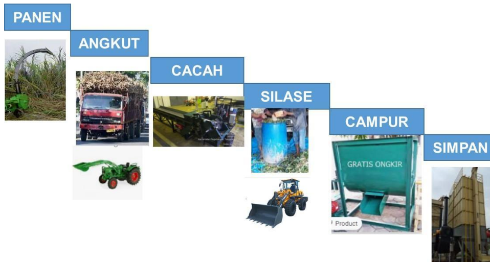
Gambar 3. Proses pengolahan pakan dari biomassa tanaman
