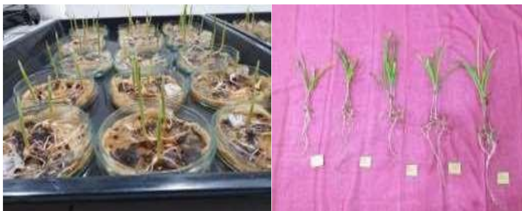
Gambar 9. Pengujian ada tidaknya senyawa fitotoksin pada kompos yang diujikan pada benih jagung di laboratorium
