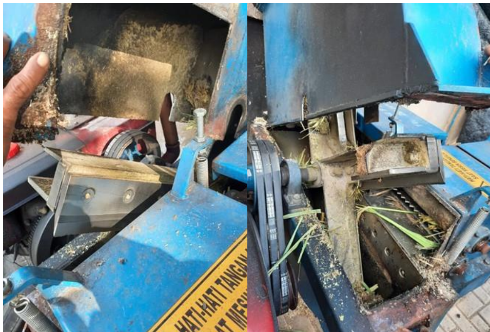
Gambar 23. Pisau dan kipas pelempar cacahan batang sorgum pada mesin pencacah tipe piringan
