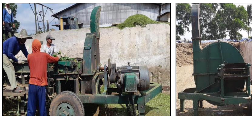
Gambar 9. Mesin pencacah tipe axial berkapasitas besar menggunakan piringan untuk mencacah biomassa tanaman jagung berkadar air tinggi yang digunakan oleh PT KASA di Lampung
