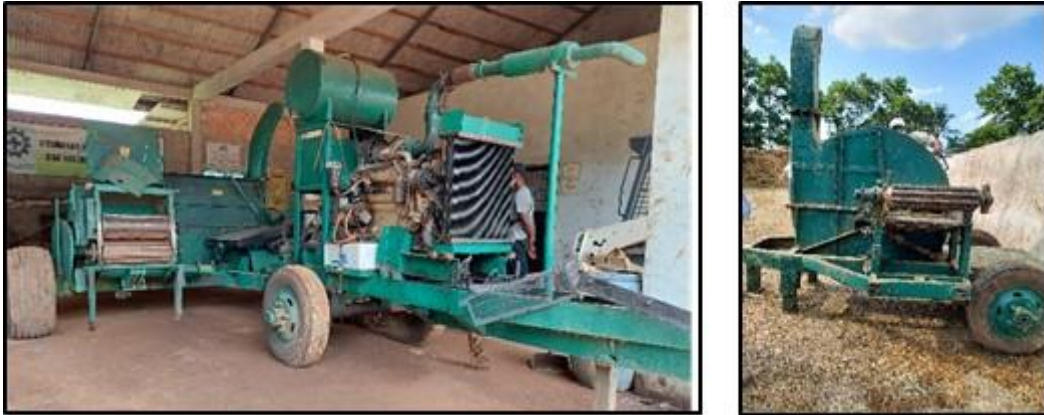
Gambar 15. Mesin chopper tipe cross flow kapasitas 10 ton/jam (a) dan axial flow kapasitas 6 ton/jam (b) yang digunakan oleh PT Karunia Alam Sejahtera
