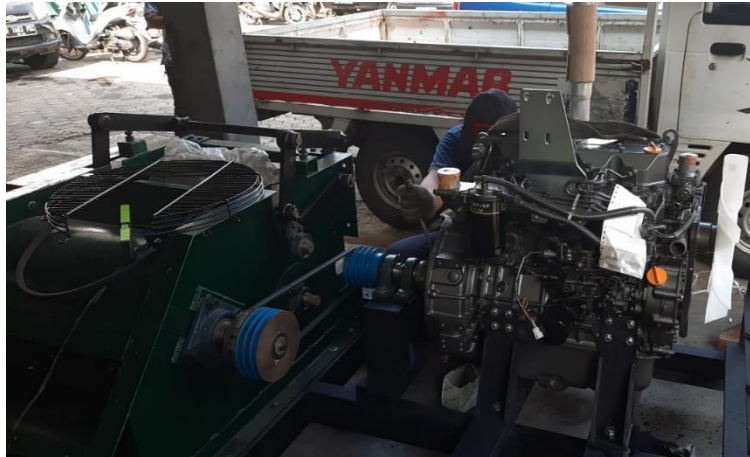
Gambar 38. Peyetelan motor penggerak diesel dengan mesin pencacah
