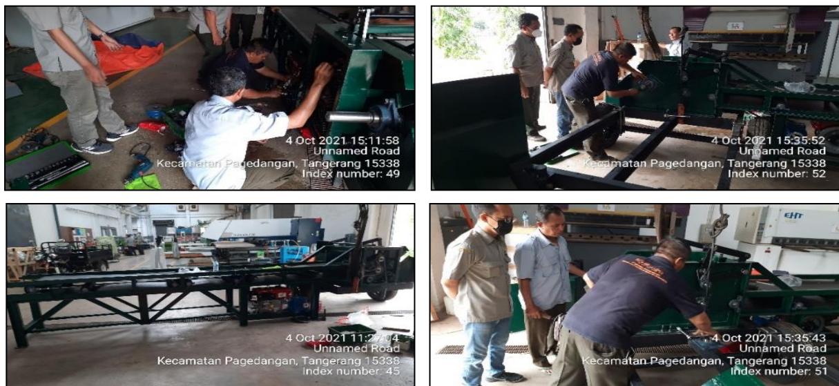
Gambar 48. Perakitan komponen: v belt dan puli, sprocket dan rantai dan belt conveyor
