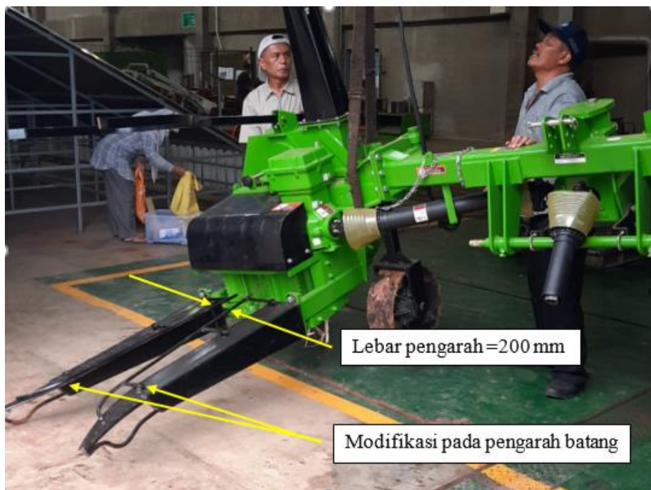
Gambar 33. Modifikasi pada bagian lebar pengarah tanaman menjadi 200 mm
