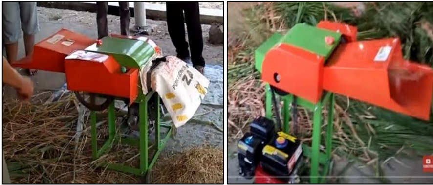
Gambar 12. Berbagai model mesin pencacah jerami tipe Cross flow buatan industri alsintan lokal dan dipasarkan didalam negeri
