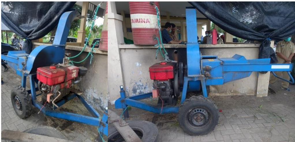
Gambar 22. Mesin pencacah sorgum tipe piringan dengan panjang cacahan <math>< 1\text{ cm}</math> yang sudah digunakan di desa Klatakan, kecamatan Kendit
