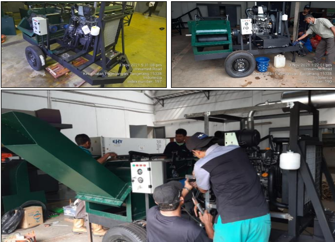
Gambar 49. Peyetelan motor penggerak diesel dengan mesin pencacah
