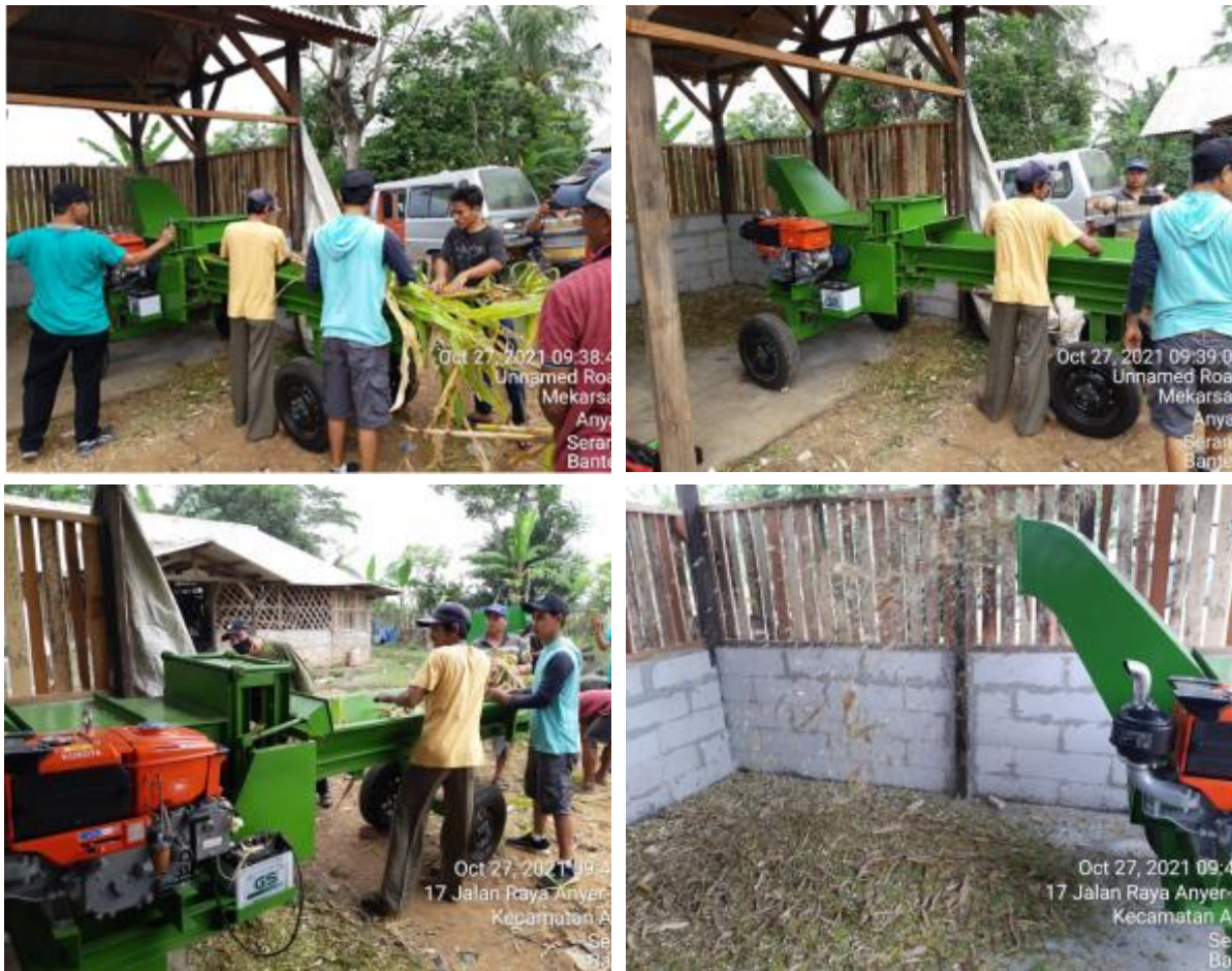
Gambar 27. Ujicoba mesin pencacah hijauan pakan ternak di lokasi PRIK
