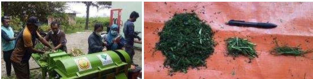
Gambar 23. Hasil Uji kinerja lapang mesin pencacah bahan uji legum
