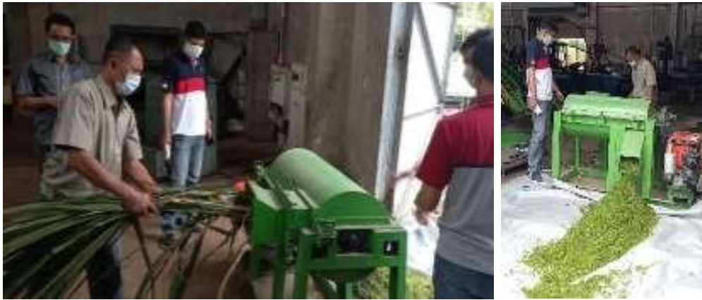
Gambar 13. Proses uji fungsional mesin pencacah
