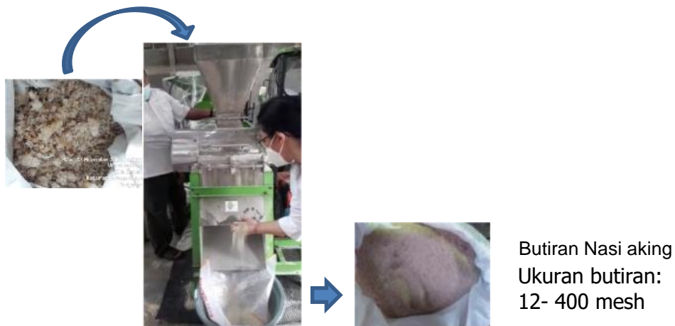
Gambar 35. Uji Kinerja mesin hammer mill dengan bahan nasi aking
