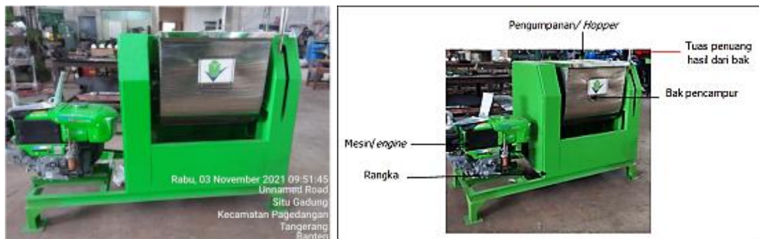
Gambar 29. Prototipe mesin pencampur ( mixer ) pakan itik
