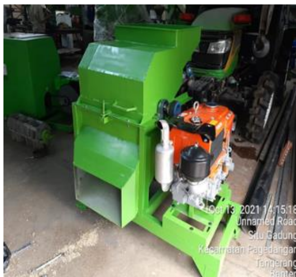
Gambar 16. Prototipe mesin penggiling ( hammer mill )
