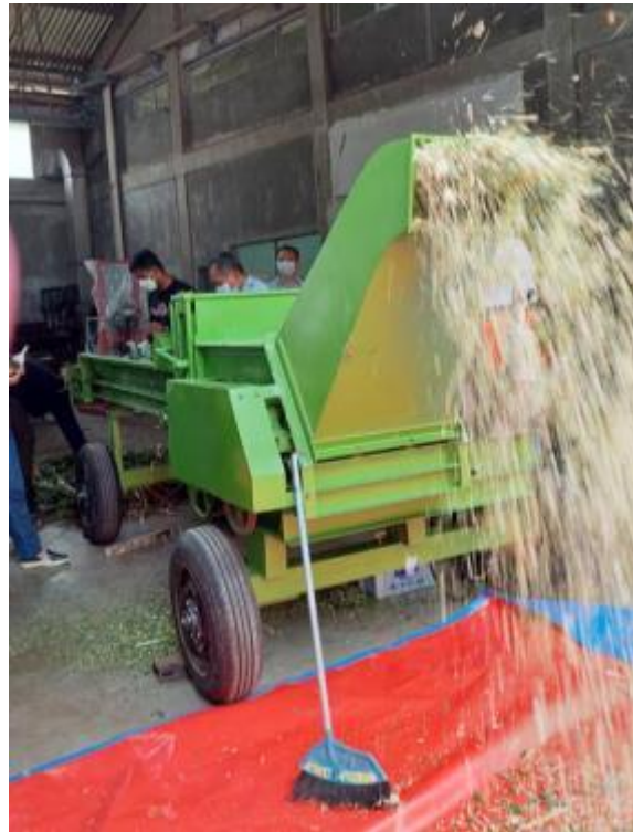
Gambar 18. Uji kinerja mesin pencacah hijauan
