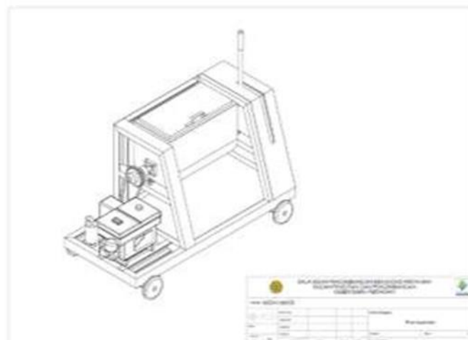
Gambar 9. Rancangan desain prototipe mesin pencampur pakan (mixer)
