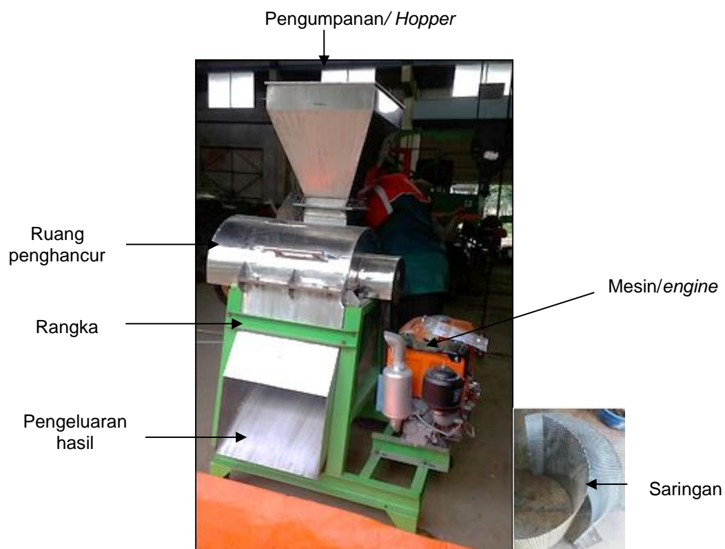
Gambar 23 . Prototipe mesin penghancur pakan tipe hammer mill
