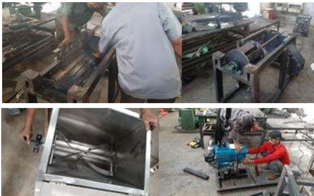
Gambar 10. Proses fabrikasi mesin pencacah dan mesin pencampur pakan
