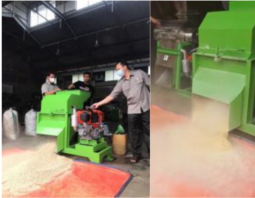
Gambar 20. Pelaksanaan uji kinerja mesin hammer mill
