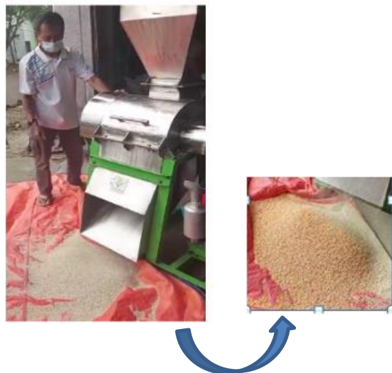
Gambar 31. Uji fungsional prototipe mesin penghancur tipe hammer mill
