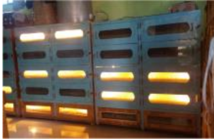
Gambar 14. Mesin Penetasan itik di desa sleman, Indramayu
