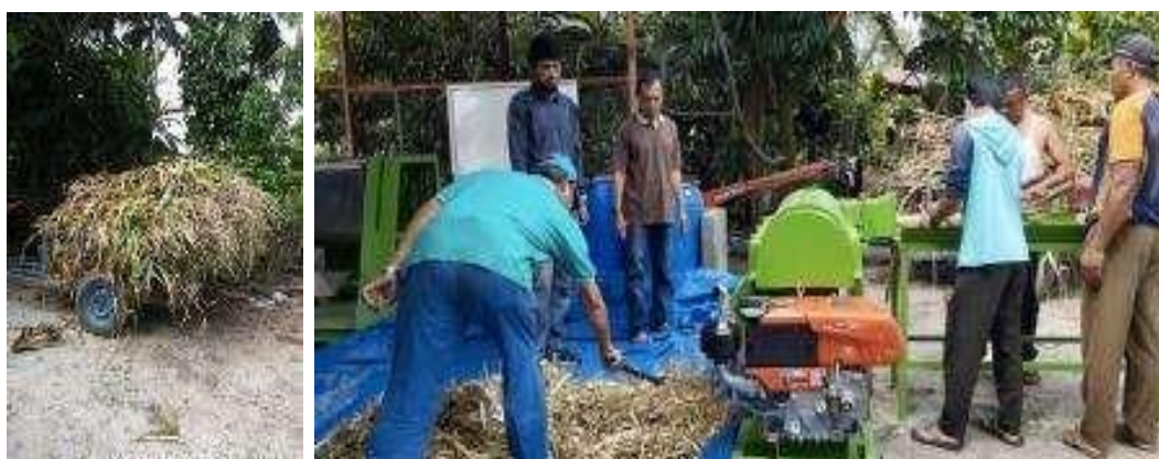
Gambar 19. Penyiapan bahan uji dan running test mesin pencacah
