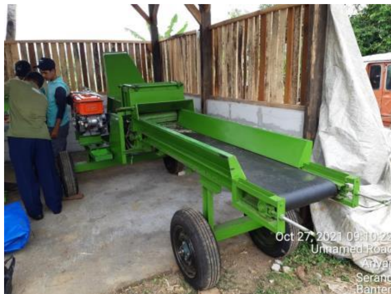
Gambar 22. Pemasangan dan setting mesin pencacah ( chopper )
