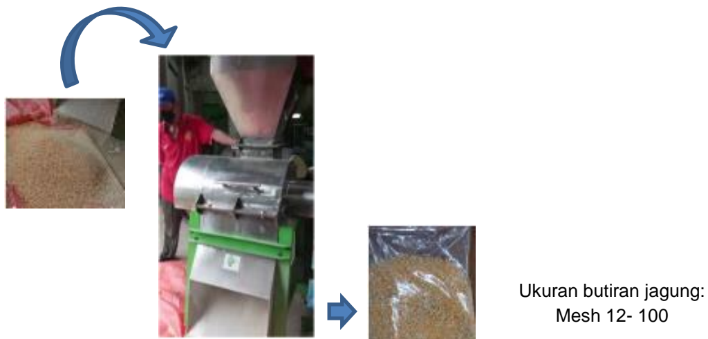
Gambar 34. Uji kinerja mesin hammer mill dengan bahan jagung pipil
