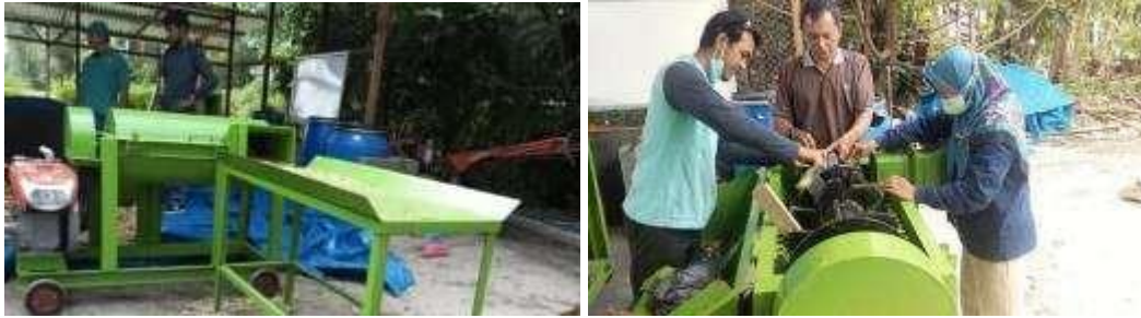
Gambar 20. Pemeriksaan mesin pencacah sebelum uji kinerja
