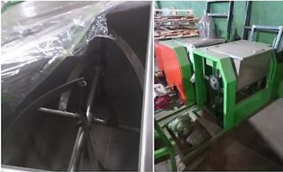
Gambar 28. Proses pabrikasi mesin pencampur ( mixer ) pakan itik
