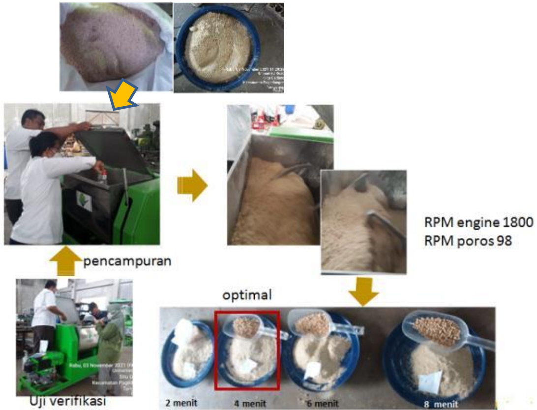
Gambar 33. Uji fungsional prototipe mesin pencampur pakan
