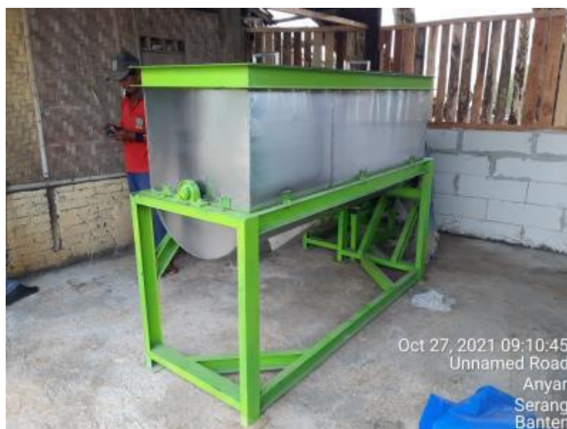
Gambar 24. Pemasangan dan setting mesin pencampur ( mixer )
