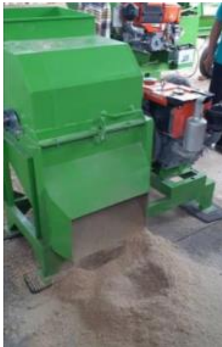
Gambar 28. Ujicoba hammer mill di lokasi RPIK
