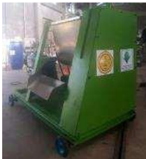
Gambar 16. Prototipe mesin pencampur ( mixer )
