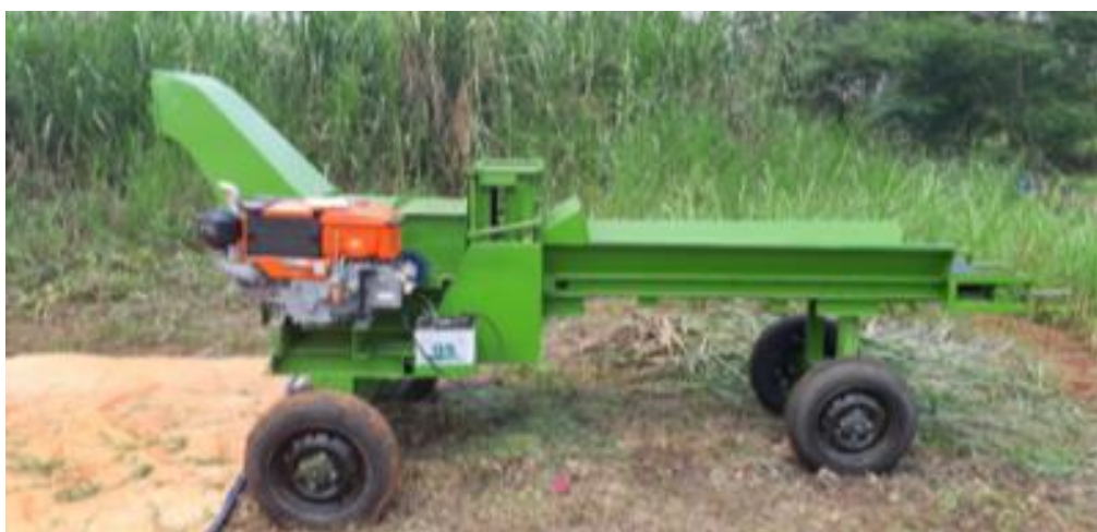
Gambar 15. Prototipe chopper hasil rekayasa
