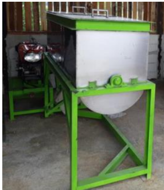
Gambar 17. Prototipe mesin pencampur ( mixer )
