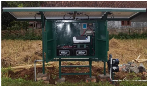
Gambar 13. Aplikasi irigasi hemat air tenaga surya berbasis android
