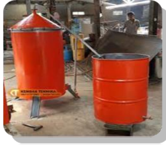
Gambar 5. Alat penyulingan minyak atsiri
