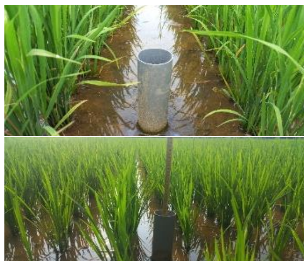
Gambar 30. Pemasangan piezometer untuk mengetahui tinggi muka air
