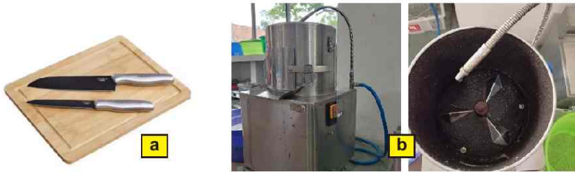
Gambar 2a. Opsi alat pengupas kentang sesuai SOP: (a) pisau stainless steel dan talenan; (b) mesin pengupas kentang.
