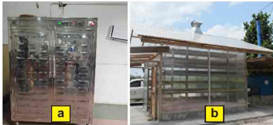
Gambar 3b. Opsi alat pengering kentang sesuai SOP: (a) oven; (b) instore dryer
