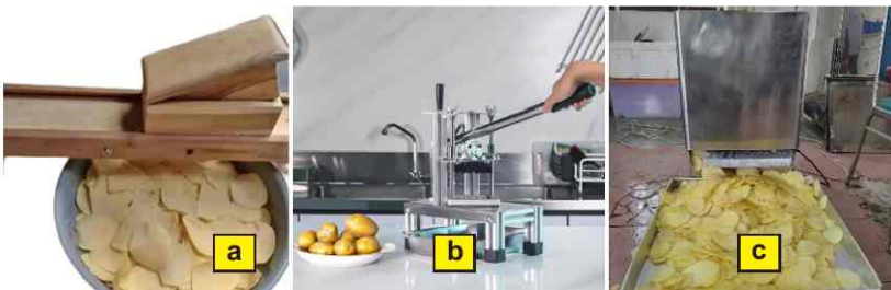
Gambar 2b. Opsi alat pengiris kentang sesuai SOP: (a) pengiris kentang manual; (b) pemotong kentang model tuas; (c) mesin slicer (pengiris)
