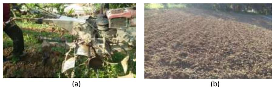
Gambar 2. Pengolahan tanah dengan traktor tangan (a) dan lahan setelah diolah (b)
