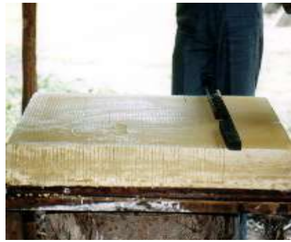
Gambar 7. Pencetakan dan pengirisan gambir dalam bentuk balok atau batangan [A] dan pencetakan dalam bentuk silindris [B].
