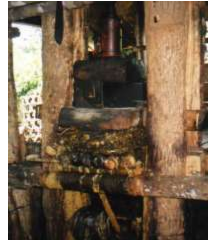
Gambar 5. Pengepresan sari daun gambir dengan alat hidraulik berkekuatan 3 ton
