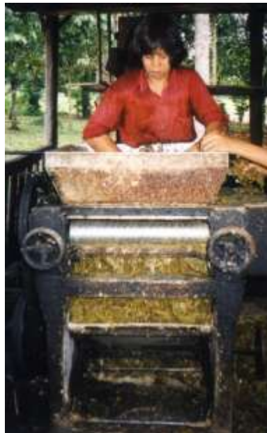
Gambar 4. Penggilingan daun gambir pascaperebusan dalam keadaan hangat
