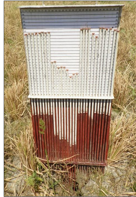
Gambar 2. Pin meter untuk mengukur kekasaran permukaan di lapangan
