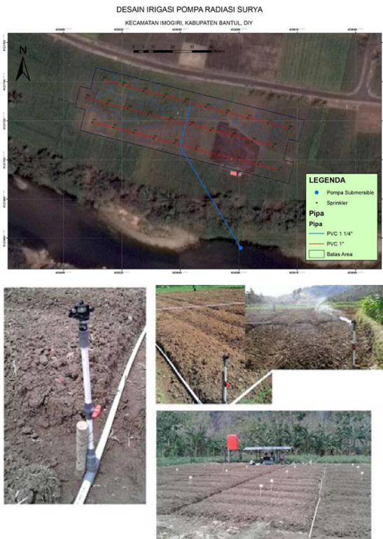
Gambar 5. Desain dan instalasi SIPTS dengan teknik irigasi impact sprinkler
