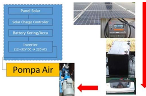
Gambar 3. Konfigurasi pompa tenaga surya
