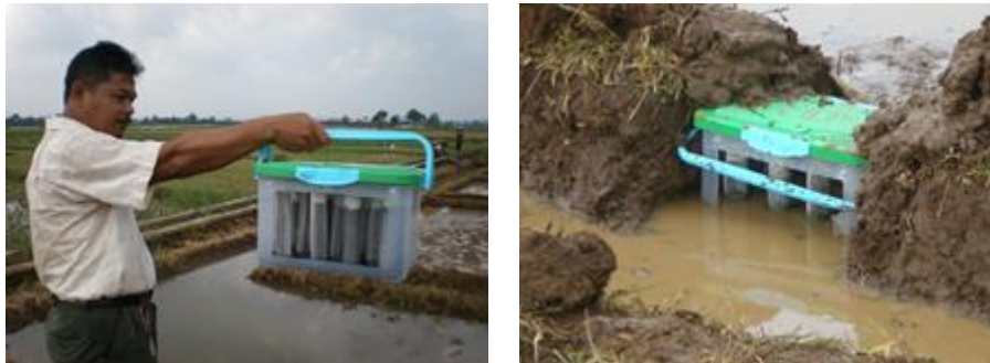
Gambar 9. Arang aktif (tempurung kelapa, sekam padi, tongkol jagung dan TKKS) sebagai filter residu pestisida di inlet dan outlet (FIO) petakan sawah (Sumber: Ardiwinata et al. 2015b)
