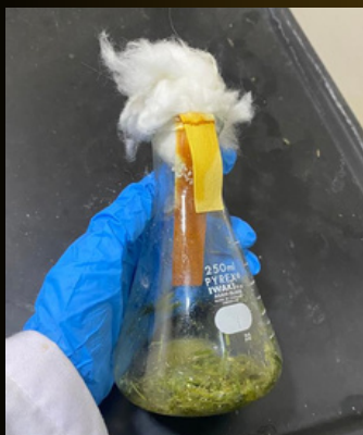
Gambar 3. Pengujian isi lambung gajah menggunakan picrate paper test
