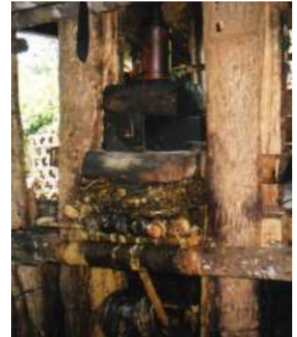
Gambar 5. Pengepresan sari daun gambir dengan alat hidraulis berkekuatan 3 ton
