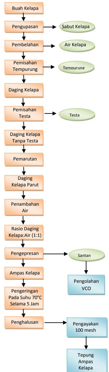
Gambar 2 Diagram alir pembuatan tepung ampas kelapa dari pengolahan VCO metode basah.
