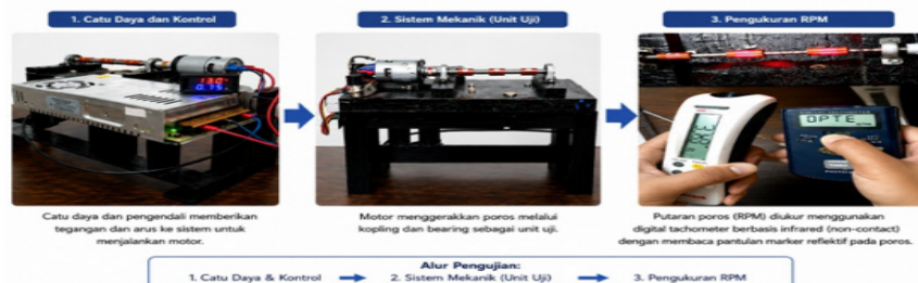
Gambar 2. Konfigurasi Sistem Pengujian dan Pengukuran Prototipe
