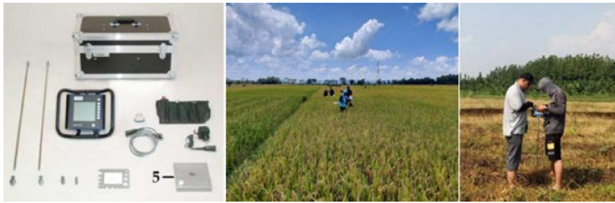
Gambar 2. mengukur daya sanggah tanah menggunakan phenetrometer .
